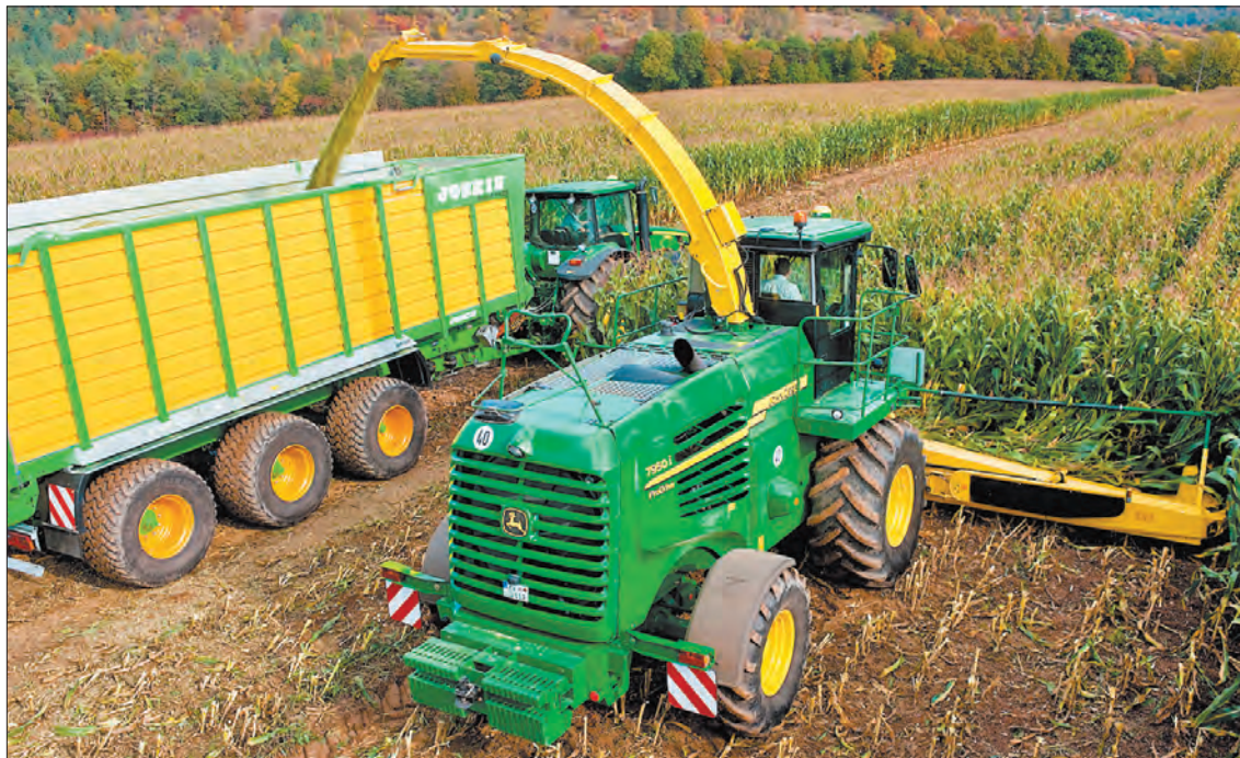
Beim Maishäckseln kommt es auf eine hohe Schlagkraft und eine gute Häckselqualität an. Da der Silomais unterschiedlich abreift, ist eine kontinuierliche Anpassung der Häcksellänge erforderlich.
